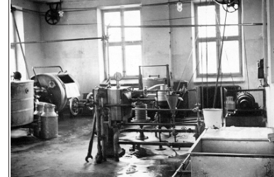
En mejerisal på 30-talet. Notera remdriften i taket och smörtrumman där grädden kärnades till smör.
